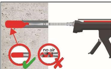
6. Bohrloch vom Bohrlochgrund (ggf. Mischerverlängerung verwenden) her ca. zu 2/3 mit Mörtel befüllen. Langsames Zurückziehen des Statikmischers vermindert die Bildung von Lufteinschlüssen. Temperaturabhängige Verarbeitungszeiten  $t_{work}$  (Anhang B 3) beachten.
